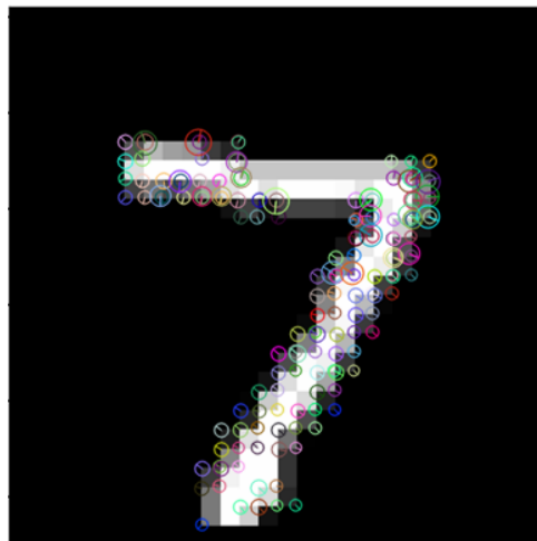
Figura 25 – Representação da detecção de pontos-chave utilizando a biblioteca OpenCV . Fonte: Elaborado pela autora.
